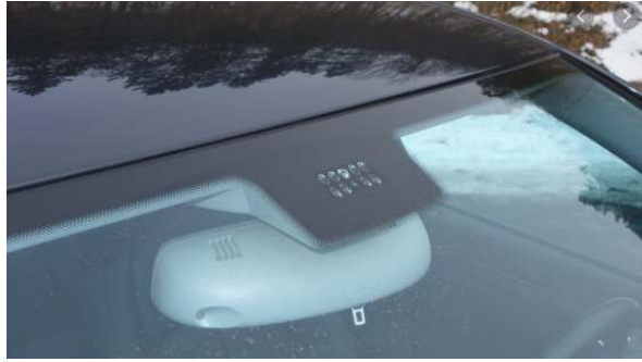
Şekil 15. Ön cama monte edilmiş yağmur sensörü [37]
