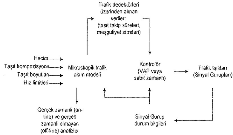
Şekil-4. VISSIM simülasyon programında simülasyon sürecini gösteren blok şema. [8]
