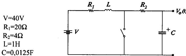
**Çözüm:**  $t=0$  anında anahtar açıldığında basamak fonksiyonu oluşur. Bu yüzden  $V(s)=V/s$  olur. Başlangıçta kapasitenin uçlarındaki gerilim sıfırdır. Bundan dolayı  $q(0^+)=0$ 'dır. Başlangıçta endüktans üzerinden akan akım  $i_L(0^+)=V/R_1$ 'dır.
