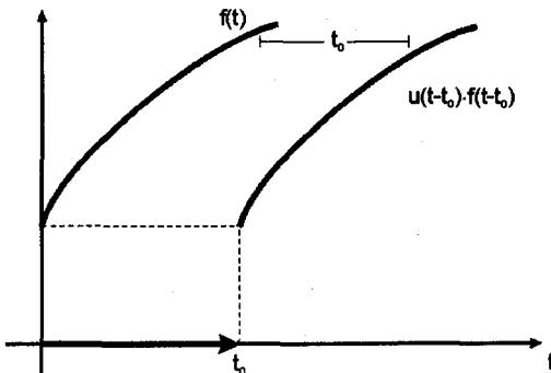
Şekil 3.5:  $f(t)$  'nin  $t_0$  birim sağa kaydırılması.
