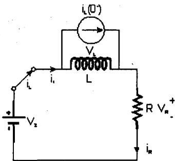
$$\begin{aligned} \text{a)} \quad & V_L(t) + V_R(t) = V_2(t) \\ & L \frac{d}{dt}[i_L(t) - i_L(0^-)] + R \cdot i_R(t) = V_2(t) = V_2 \cdot U(t) \\ & L \frac{di_L(t)}{dt} + R \cdot i_R(t) = V_2 \cdot U(t) \end{aligned}$$
