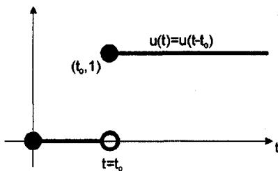
Şekil 3.3:  $t=t_0$  noktasında  $u(t)$  birim basamak fonksiyonunun sıçraması
