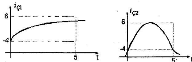
$$\text{e)} \quad \zeta 1: \quad i_{C1gh}(t) = \left( -\frac{5}{2}e^{-0,6t} + \frac{1}{2}e^{-t} \right) \cdot U(t) \quad [\text{A}]$$
