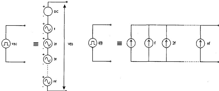
Şekil 4.2: Periyodik gerilim ve akım kaynağının FOURIER dönüşümü
